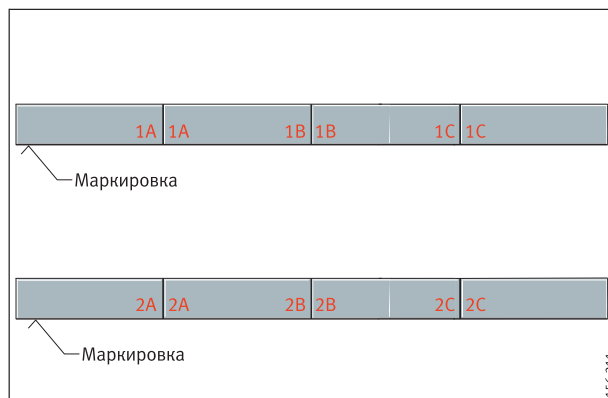
Рисунок 5 · Обозначение частей составного рельса
